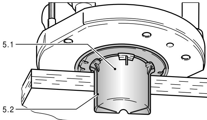
Le récupérateur de copeaux KSF-OF (5.1) (en partie dans l'équipement standard) accroît l'efficacité du système d'aspiration lors des opérations d'affleurement.
