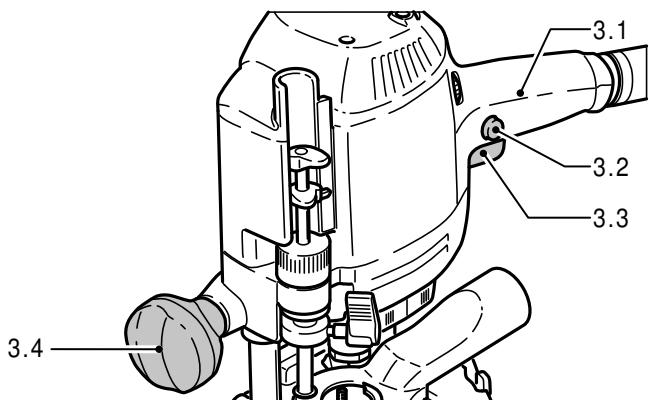
**!ADVERTENCIA** Tras la desconexión de la máquina, la fresa continúa girando en inercia durante un momento. ¡Proceda con cuidado, para evitar que la fresa entre en contacto con alguna parte de su cuerpo mientras continúa girando en inercia!
