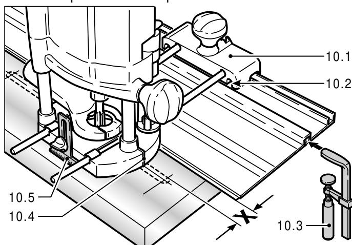
Para poder trabajar con un patrón, la marca en la base de la fresadora (10.4) y la escala del apoyo (10.5) le indican el eje medio de la fresa.
