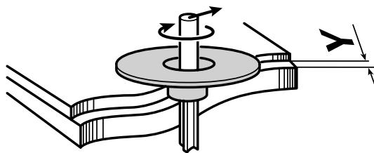
$$Y = \frac{1}{2} (\varnothing \text{ de la bague de copiage} - \varnothing \text{ de la fraise})$$
