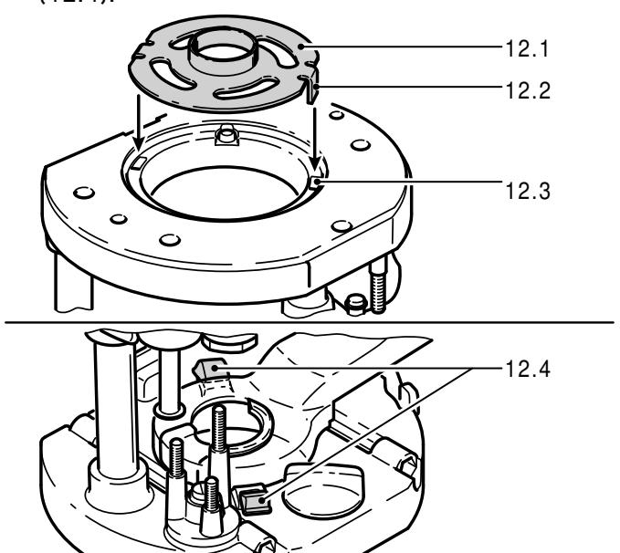
**ATTENTION** Lors du choix de la taille de la bague de copiage, veillez à ce que le diamètre de la fraise utilisée corresponde au diamètre de la bague.
