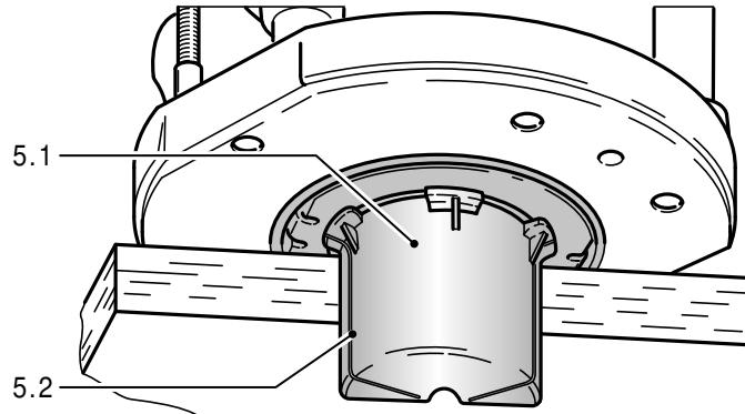
Mediante el colector de virutas KSF-OF (5.1) (parcialmente en el suministro) se puede aumentar la efectividad de la aspiración al fresar cantos.
